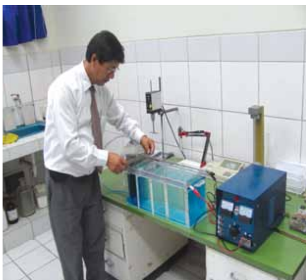
Figura N.º 8. Puesta en operación y ensayo de electrodeposición de cobre a partir de una solución de lixiviación.
