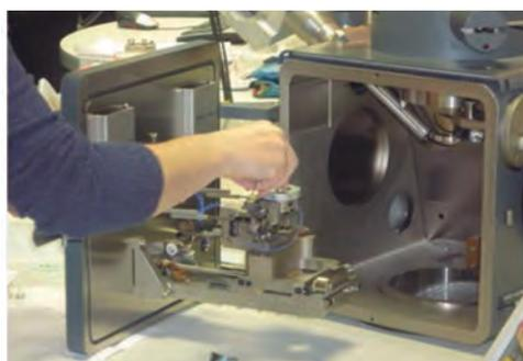
Figura 10. Colocación de una muestra en el equipo SEM.
