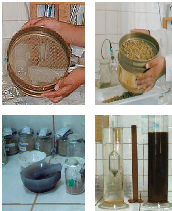
Figura 2. Ilustración de los instrumentos para obtener la fracción arcilla por sedimentación.
