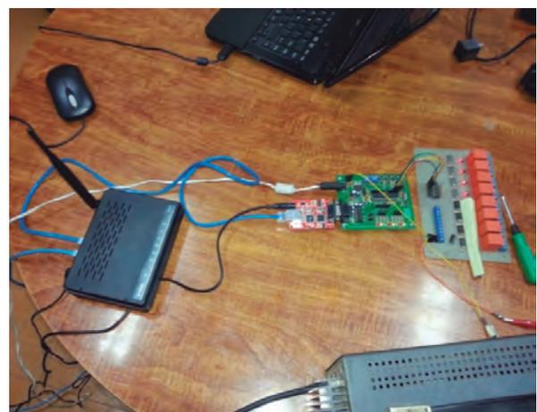
**Figura 5.** Pruebas de comunicación entre las diferentes partes.
