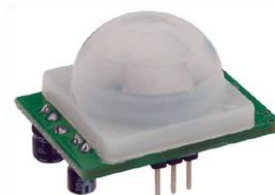
Fig. 10. Sensor de movimiento (PIR).
