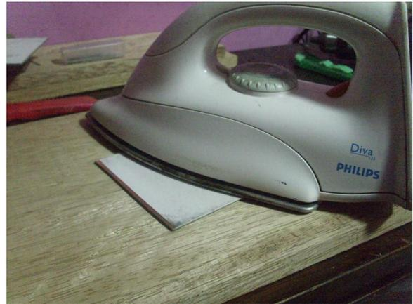
**Fig.15.** Fabricación casera del pcb.
