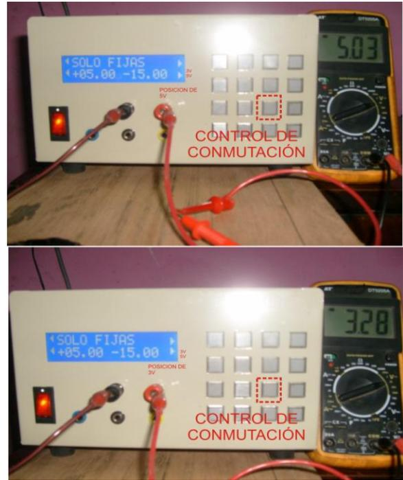
Fig.26. Visualización de voltajes de la fuente fija.
