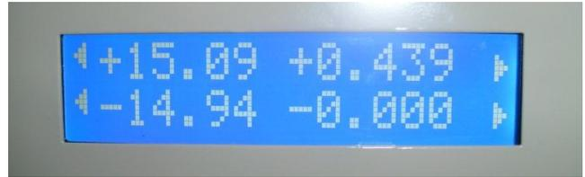
Fig. 35. Corriente consumida por la carga.
