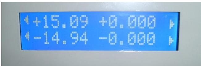
Fig. 34. Voltaje corregido con la opción CAL en la fuente positiva.
