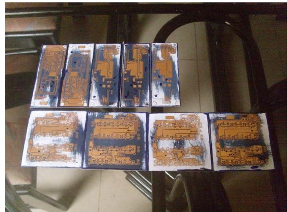
**Fig.16.** Tarjetas con la transferencia de toner.
