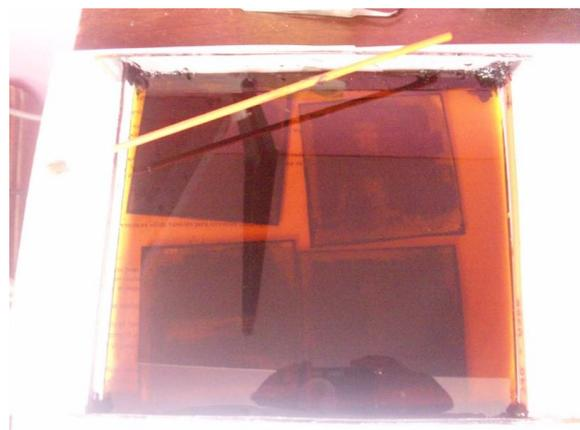
**Fig.17.** Inserción de las tarjetas en ácido.
