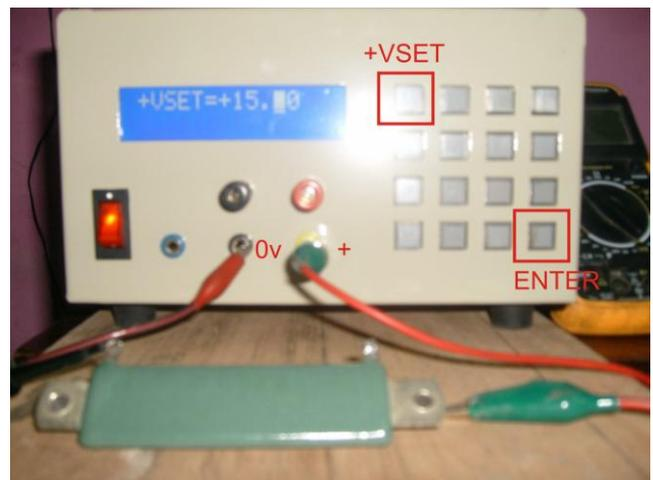
Fig. 31. Configuración del voltaje positivo.
