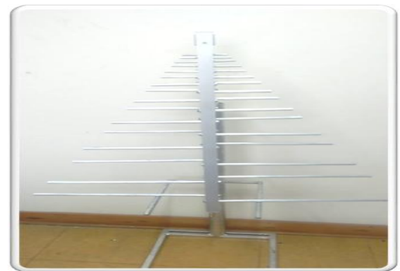
Fig.13. Antena logoperiódica concluida.
