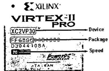
Fig. 5. Información impresa en el circuito integrado.
