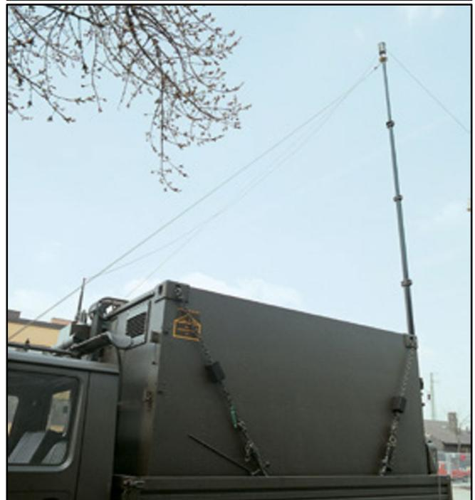
**Fig. 6.** Antena dipolo de cable de 2 MHz a 90 MHz 25 W para aplicaciones de mochila (o equipo portátil) & Sistema de antena HF de 1.5 MHz a 30 MHz 150 W para aplicaciones en vehículos
