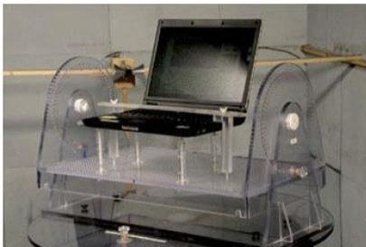
**Fig. 1.** Sistema de posicionamiento manual de la Health Protection Agency's
