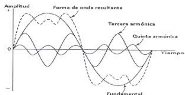
Fig. 8. Suma de armónicas impares en cantidades proporcionales para obtener la onda cuadrada.
