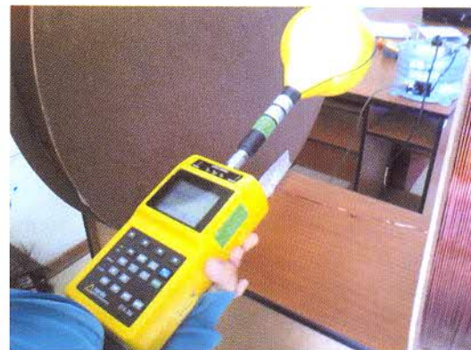
Fig. 8 Mediciones realizadas para comprobar el desempeño de las bobinas de Helmholtz utilizando analizadores de radiaciones no ionizantes de baja frecuencia del INICTEL-UNI
