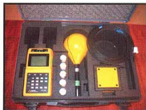
Fig. 1 Analizador de Campo Electromagnético de Baja Frecuencia EFA-300.
