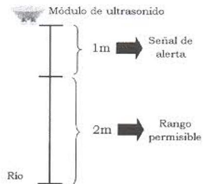
Fig. 7. Escala de medición permisibles y alerta de peligro.
