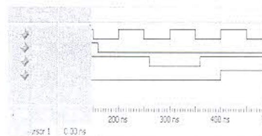
Fig. 25. Simulación del comportamiento del Multiplicador en ModelSim.
