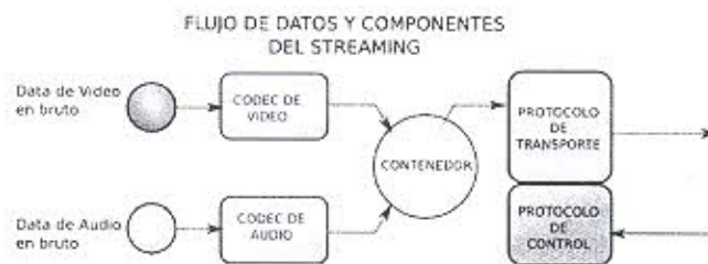
Fig. 3. Flujo de datos entre procesos del Streaming
