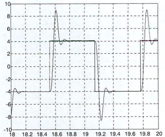
Fig. 20. Entrada y salida de lazo cerrado para control PID sintonizado a partir de la prueba de modo relay y aproximado con T=1\text{msg} .
