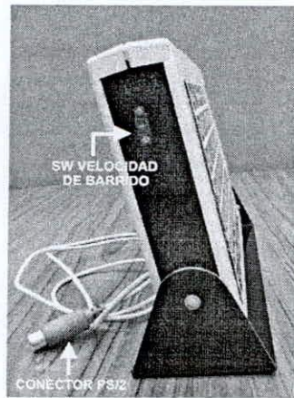
Fig. 8. Teclado de barrido (vista lateral)
