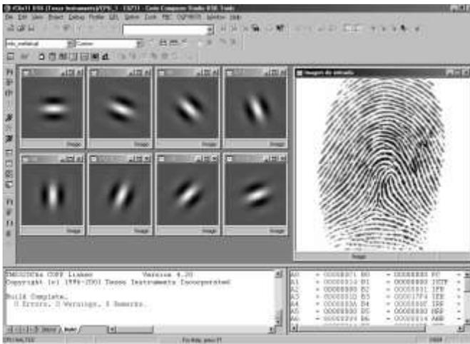
Fig.5. Implementación de los ocho filtros de Gabor bidimensionales de diferentes orientaciones empleando el CCS
