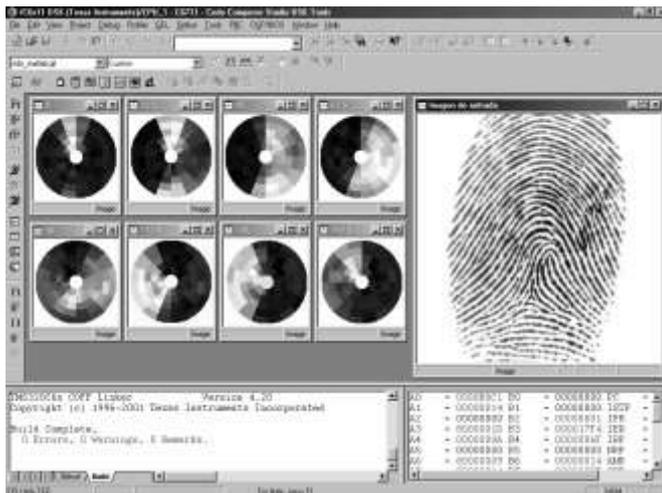
Fig.8. Implementación del extractor del vector de características basado en la varianza empleando el CCS.
