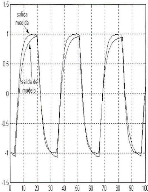
Fig. 2. Respuesta medida y respuesta del modelo discreto de primer orden.
