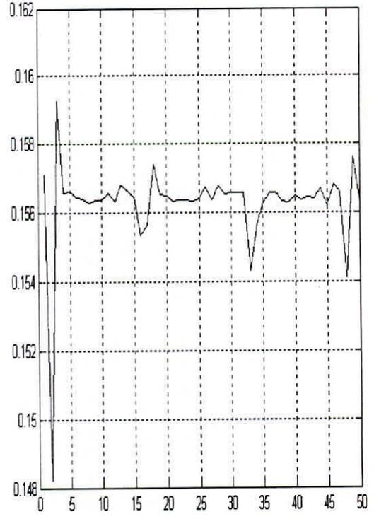
Fig. 6. Variación del cálculo recursivo del parámetro a, del modelo de segundo orden.
