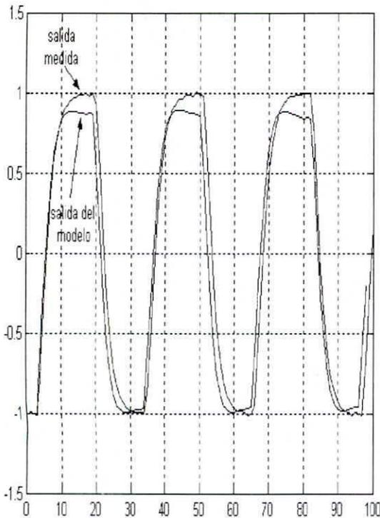
Fig. 3. Respuesta medida y respuesta del modelo discreto de segundo orden.
