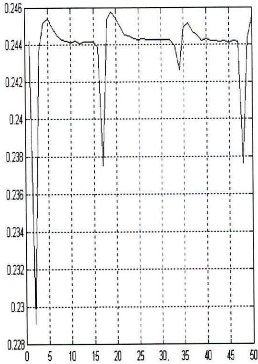
Fig. 4. Variación del cálculo recursivo del parámetro a, del modelo de primer orden.
