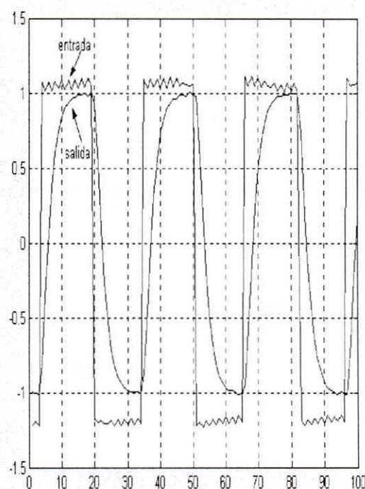
Fig. 1. Datos de entrada y salida para identificación por mínimos cuadrados
