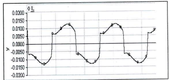
Fig. 18. Formas de onda de corriente en los terminales de entrada del rectificador monofásico.
