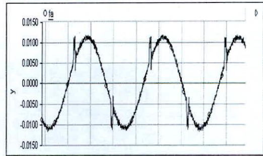
Fig. 35. Formas de onda de la señal de modulación generada por el control.
