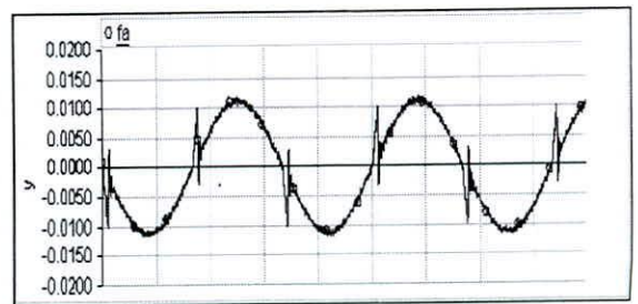
Fig. 19. Formas de onda de la señal de modulación generada por el control.
