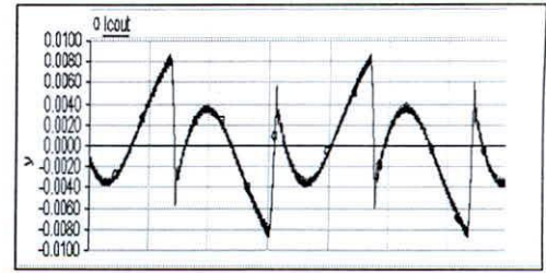
Fig. 23. Formas de onda de la corriente de salida del FAP e inyectada en los terminales de entrada del rectificador
