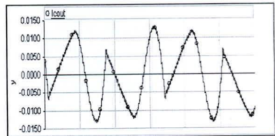
Fig. 13. Formas de onda de la corriente inyectada por el filtro activo de potencia.
