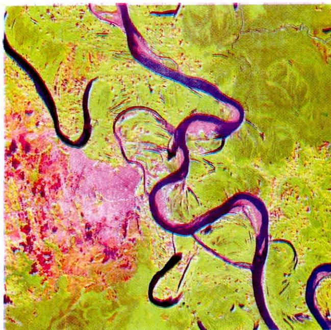
Fig. 5. Composición de bandas R: 5, G: 4 y B: 3 para la imagen LANDSAT-5 TM del 21 septiembre de 2000.
