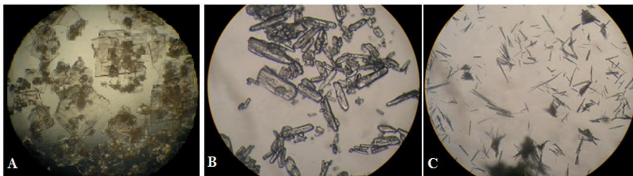
**Figura 3.** Cristales formados por reacción de AINES con tiocianato de cobalto (III); **A** laminares cuadrangulares con diclofenaco sódico 75mg/3mL; **B** monoclinico con ibuprofeno 75mg/5mL; **C** aciculares con naproxeno sódico 75mg/5mL observados al microscopio 10x10.
