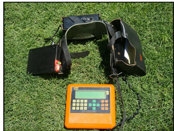
Figura 3. Instrumento ABEM WADI del año 1989 usado en la prospección geofísica.
