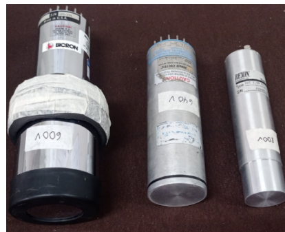
Figura 3: De izquierda a derecha, tres detectores de diámetro de cristal: 3"x3", 2"x2" y 1.5"x1.5".
