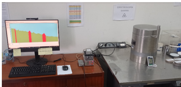
Figura 2: Cadena para espectroscopia gamma donde se aprecia a la derecha el blindaje para el detector.
