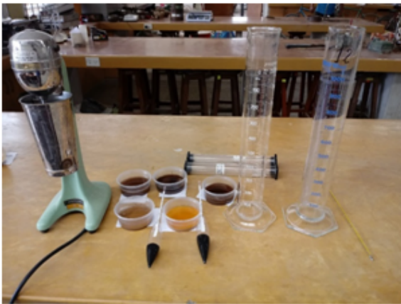
Figura 2: Equipo para análisis granulométrico – método del hidrómetro. Fuente: elaboración propia.
