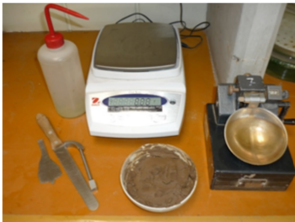
Figura 3: Equipo para ensayo de límites de consistencia. Fuente: elaboración propia.
