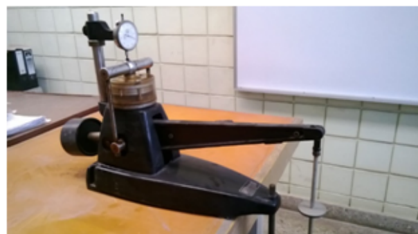
Figura 6: Equipo para ensayo de consolidación unidimensional. Fuente: elaboración propia.
