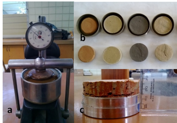
Figura 5: a) Equipo para ensayo de expansión controlada. b) Ensayo de límite de contracción. c) Ensayo de expansión libre. Fuente: elaboración propia.
