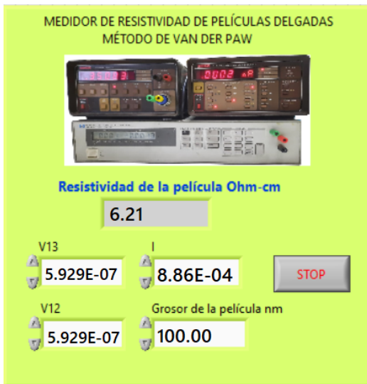
Figura 4: Panel frontal (MP) para medir la resistividad de la película.
