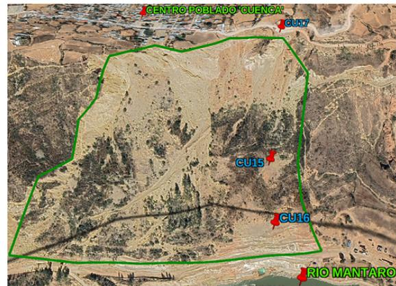
Figura 3: Visualización del deslizamiento de Cuenca y las ubicaciones de las estaciones geodésicas de interés: CU15, CU16 y CU17. La última medición GPS fue realizada el 27 de noviembre de 2023.
