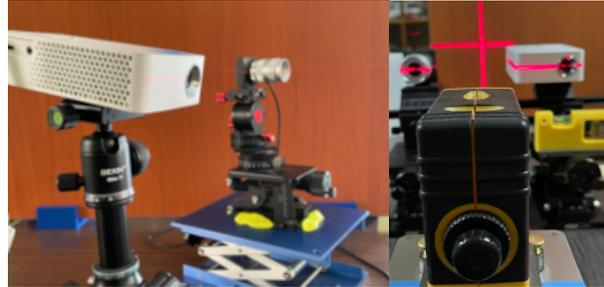
**Figura 1:** Se muestra el alineamiento de la cámara y el proyector LG en un ángulo  $\sim 11^\circ$ .
