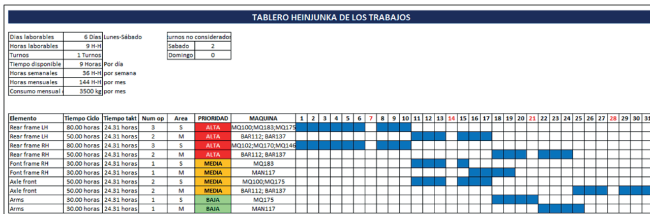
Figura 9. Tablero HEINJUNKA de los trabajos.
