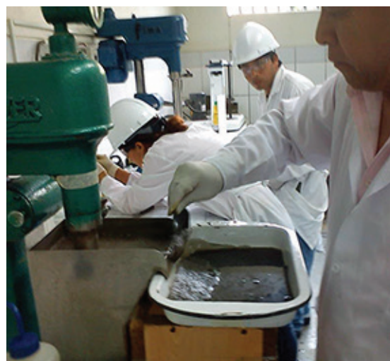
Figura N.º 2. Pruebas de Flotación del Mineral Proyecto Hilarión-Milpo.
