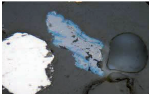
Figura N.º 8. Granos libres de pirita (py). Mixtos de esfalerita/covelita/estannita (ef/cv/esn)
