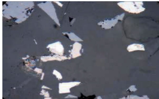
Figura N.º 6. Granos libres de pirita, pirrotita y esfalerita. Granos mixtos de pirita/pirrotita.
