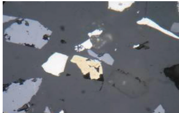
Figura N.º 5. Granos libres de calcopirita (cp), pirita py y esfalerita.
