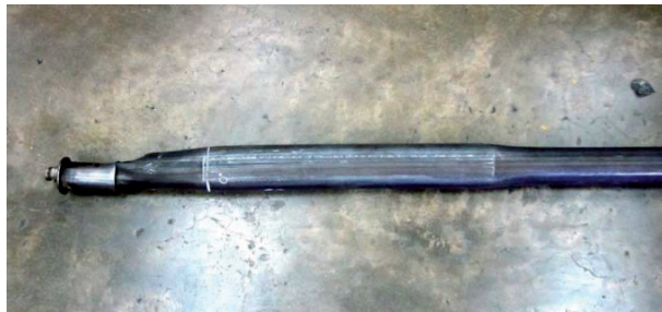
Figura N.º 3. Hydrabolt cargado después de la compresión en su cabeza con soldadura horizontal (0°).
