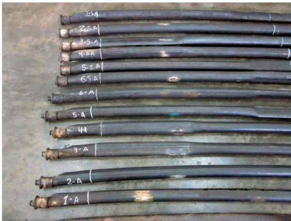
Figura N.º 1. Marcado de los pernos Hydrabolts cargados y descargados en su cabeza.
