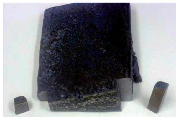
**Figura N.º 5.** Cuña de hierro fundido obtenida de la primera colada y donde se aprecia las muestras cortadas para el análisis metalográfico.
