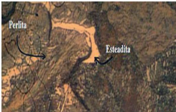
**Figura N.º 8.** Micrografía a 500X con ataque nital 2%. Se aprecia una matriz perlítica. Presencia de esteadita.
