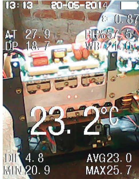
Figura N.º 10. Temperatura de equipo de soldeo sistema de enfriamiento.
