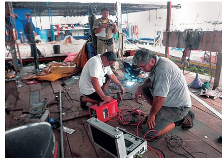
Figura N.º 12. Soldeo en el rio Amazonas a 174 msnm, monitoreo con equipo MINI ARC LOGGER II de TVS Meter.
