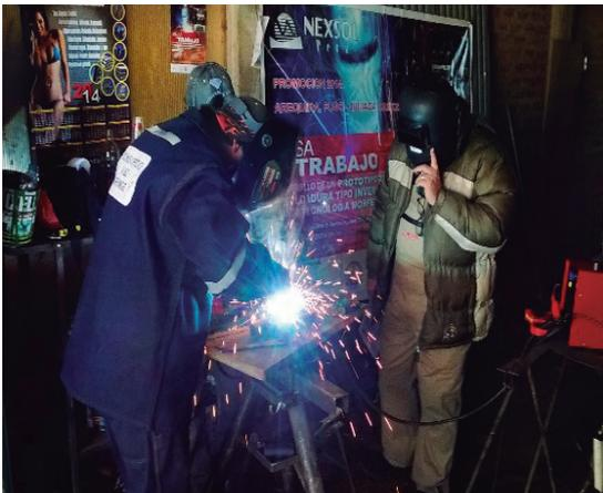
Figura N.º 13. Soldeo en ciudad Puno a 3886 msnm, monitoreo efectuado con equipo MINI ARC LOGGER II de TVS Meter
