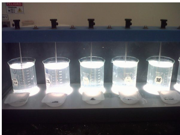
Figura N.º 03. Agitación en vasos precipitados.
