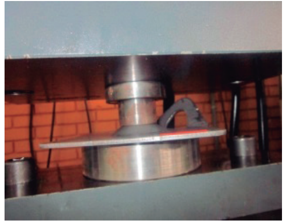
Figura N° 2. Montajes para los ensayos de compresión.
