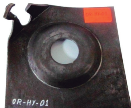
Figura N° 8. Placa esquinada después del ensayo de tracción en la oreja.
