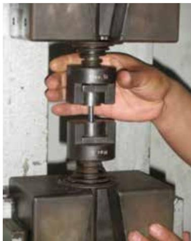
Figura N°5. Esquema de preparación de probetas para calificados de electrodos AWS/ASME SFA 5.4/ SFA 5.4M.
