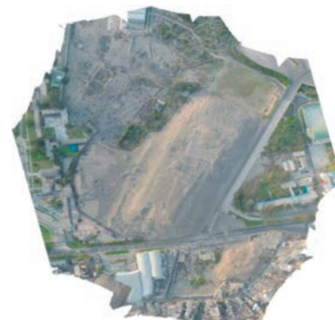
Figura N° 7. Ortofoto procesado con el software Agisoft photoscan, vuelo programado de 125 m y con una resolución espacial de 7.6 cm.
