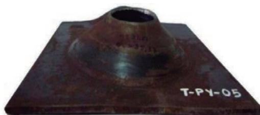
Figura N° 11. Placa Python después del ensayo a la tracción en posición invertida.
