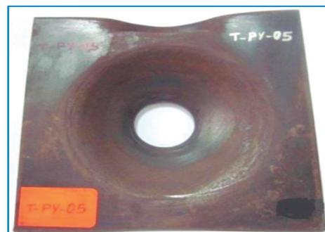
Figura N° 10. Placa Python después del ensayo a la tracción
