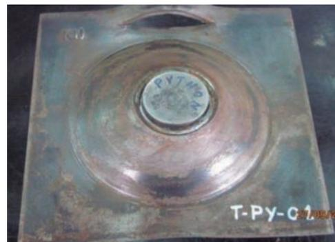
Figura N° 9. Prueba de tracción en proceso sobre la placa Python.
