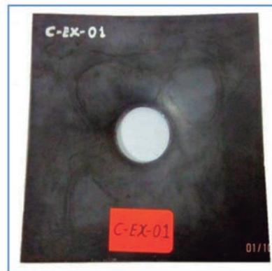
Figura N° 19. Placa Expanbol después del ensayo de compresión
