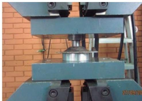
Figura N° 3. Prueba de compresión en proceso sobre las placas Python.
