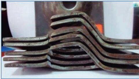
Foto N° 15. Placas Python después del ensayo de tracción en la oreja
