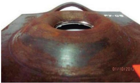
Figura N° 5. Deformación de la placa por compresión visto por el lado convexo del domo.
