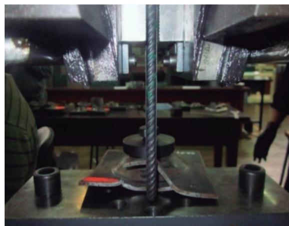
Figura N° 14. Fin del ensayo de tracción en la oreja de la placa Python
