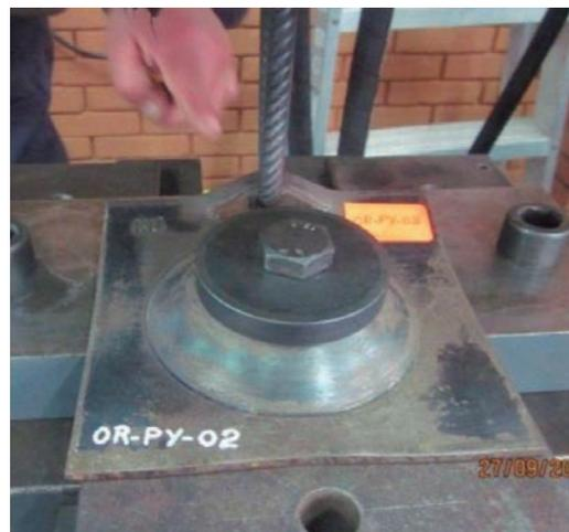
Figura N° 13. Ensayo de tracción en la oreja de la placa Python en proceso
