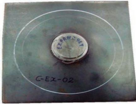
Figura N° 20. Estado final de las placas Expanbol después de la compresión.
