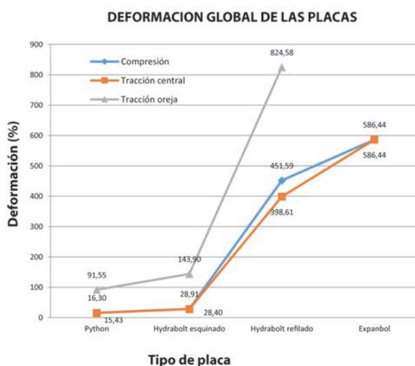
Figura N° 26. Deformación global de las placas de acuerdo al tipo de ensayo
