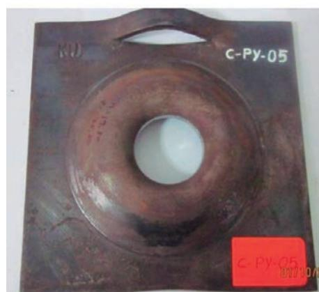
Figura N° 4. Placa Python después del ensayo a la compresión.
