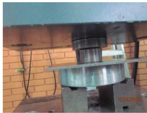
Figura N° 18. Ensayo de compresión en proceso sobre la placa Expanbol
