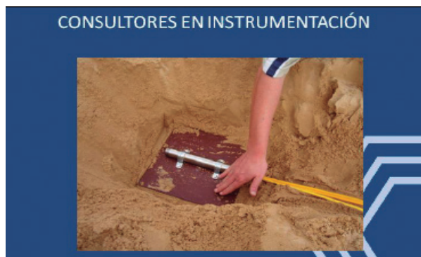
Figura N° 18. Muestra cómo se coloca un sensor que registra movimientos verticales horizontales y antero posteriores.
