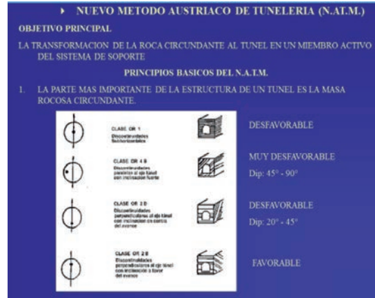
Figura N° 27. Se observan las diferentes proyecciones de los estratos (rocas sedimentarias) o pseudo-estratos (rocas ígneas, mantos estratificados por su fracturamiento o zona de contacto) y su influencia en la estabilidad del macizo.
