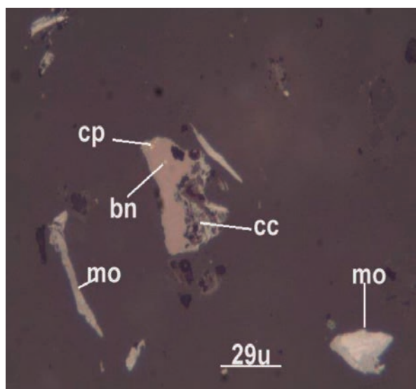
Figura N° 3. Partículas libres de molibdenita (mo) y partículas entrelazadas de molibdenita (mo) y calcosita (cc). Magnificación: 200X
