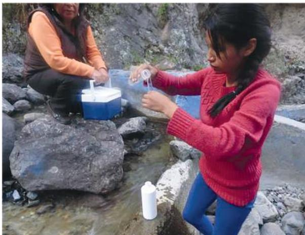
Figura N.º 9. Estabilización de metales de la muestra del riachuelo Ahuay con  $\text{HNO}_3$
