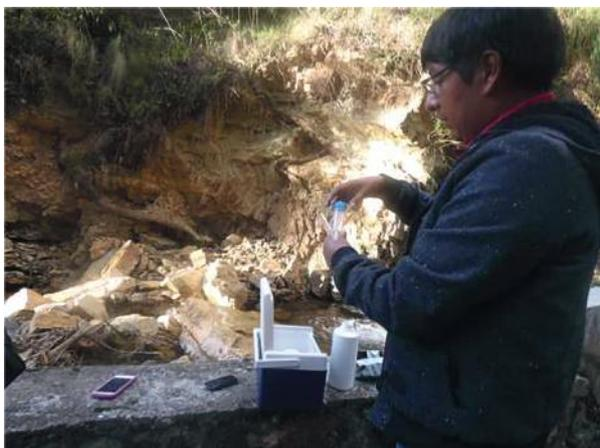
Figura N.º 6. Proceso de estabilización de los metales en agua con  $\text{HNO}_3$ .
