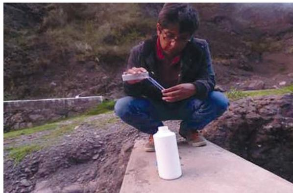
Figura N.º 11. Estabilización de metales de la muestra del río Sicra con  $\text{HNO}_3$ .
