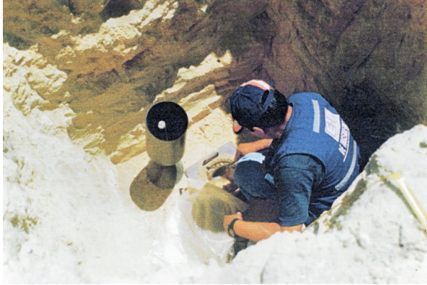
Figura N.º 2: Calicata en la línea de transmisión de la zona minera de Orcopampa, Arequipa.
