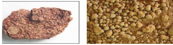
Figura N.º 5. Detalles de los pisolitos cohesionados (imagen izquierda) constituyendo una costra y pisolitos sueltos (imagen derecha) en matriz arcillosa amarilla.
