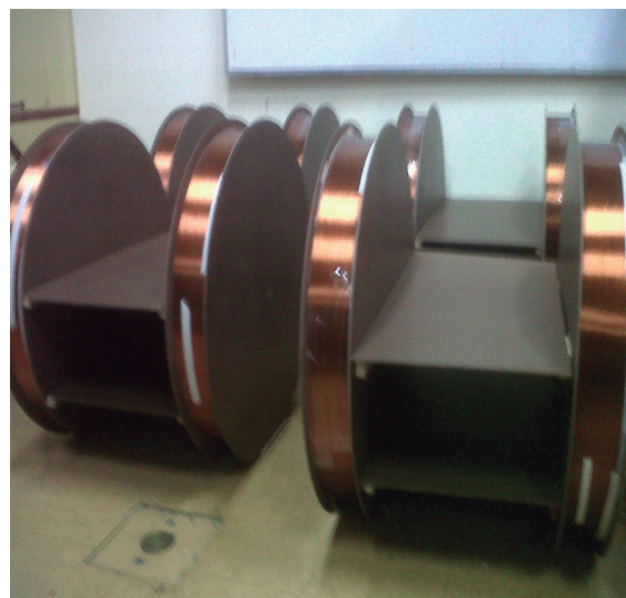
Figura N.º 3. Sistema de exposición a campos magnéticos.
