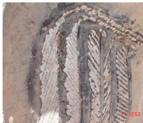
Figura N° 1. Neumático reforzado con mallas de acero. Gentileza Minera El Tesoro y empresa Bailac.
