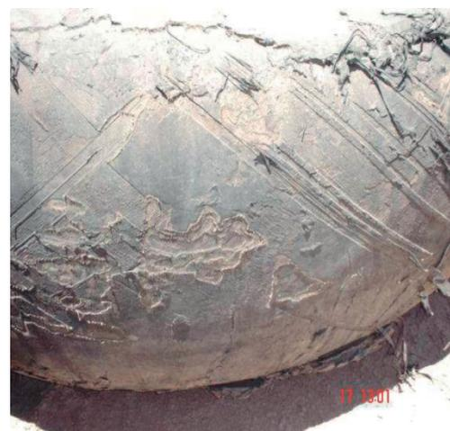
Figura N° 2. Neumático con mallas de nylon.
