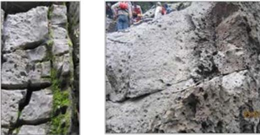
**Figura N° 10 y Figura N° 11: Grainstone (Grst)**, Calizas de textura grano soportado no mayor a 2mm con escasa matriz, buena porosidad visible de tipo móldica – vugular, potencial roca reservorio. (Dunham, R.J. 1962)
