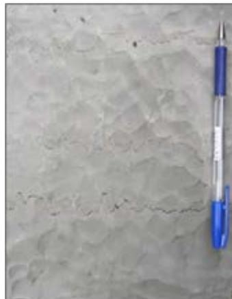
Figura N° 8: **Wackestone (Wckst)**, Calizas de textura matriz soportado con más del 10% de granos (fósiles) menores a 2 mm, se observan estructuras estilolitas. Con porosidad de fractura, potenciales rocas sello. (Dunham, R.J. 1962).
