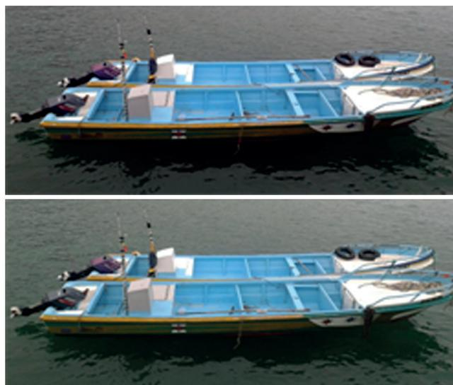
Figuras N° 2. Embarcaciones de fibras de vidrio
