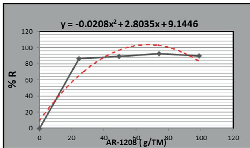
**Figura N°2.** Porcentaje de recuperación en función a la dosificación del colector.
